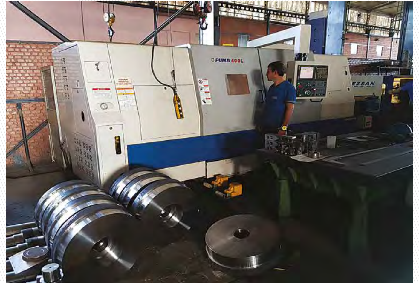
CNC Horizontal Lathe / Ø: 700 mm, L: 2.000 mm CNC Yatay Torna / Ø: 700 mm, L: 2.000 mm
