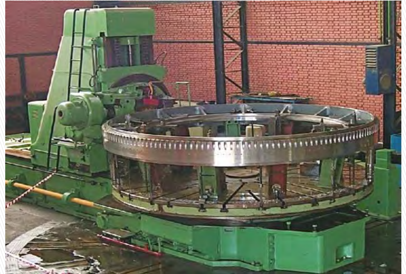
Gear Cutting Machine / Ø7.000 mm Modul: 42 Dişli Açma Tezgahı / Ø7.000 mm Modul: 42
