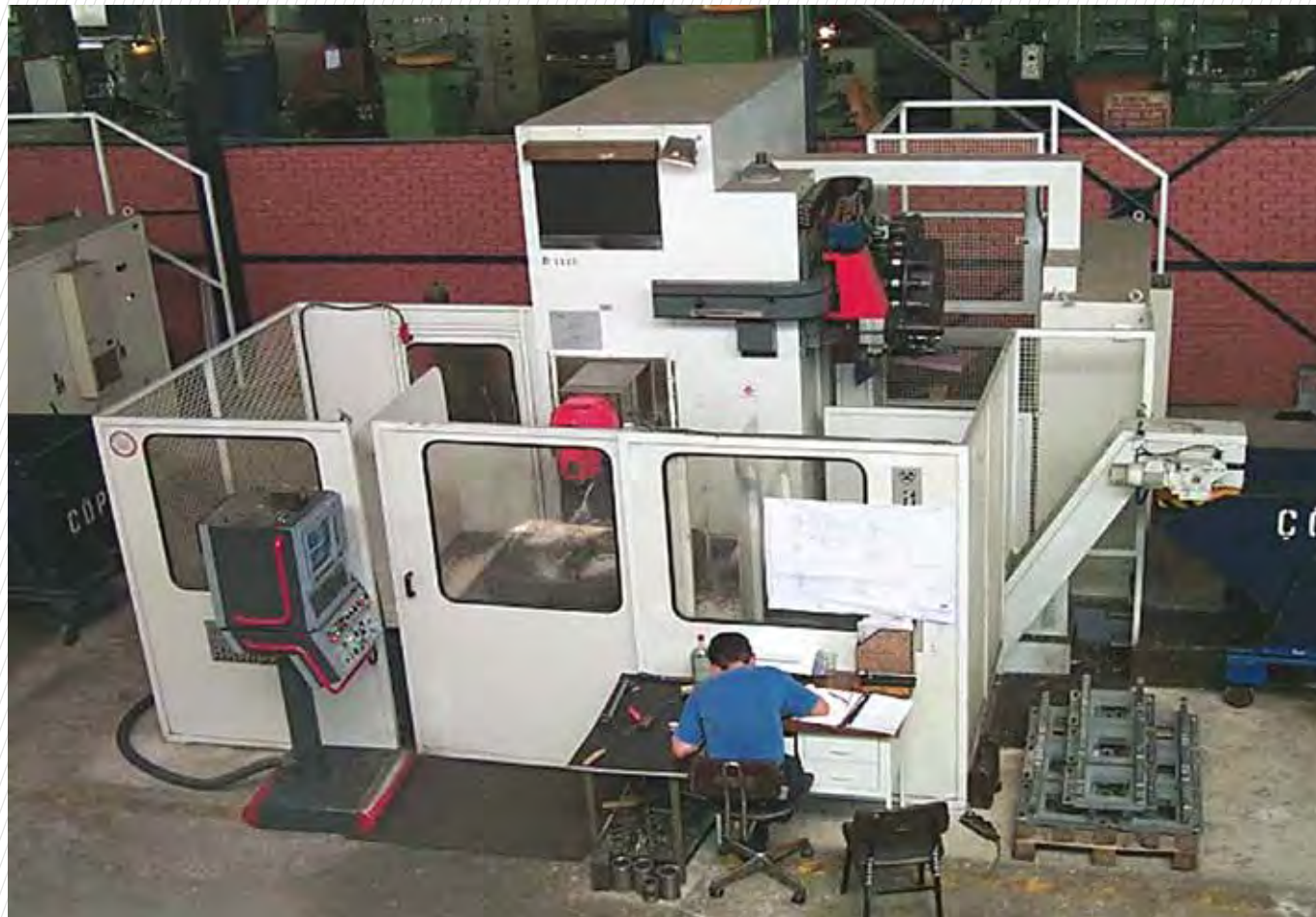
Rambaudi Versamatic 750CN x: 4.000 mm, y: 750 mm, z: 1.000 mm
