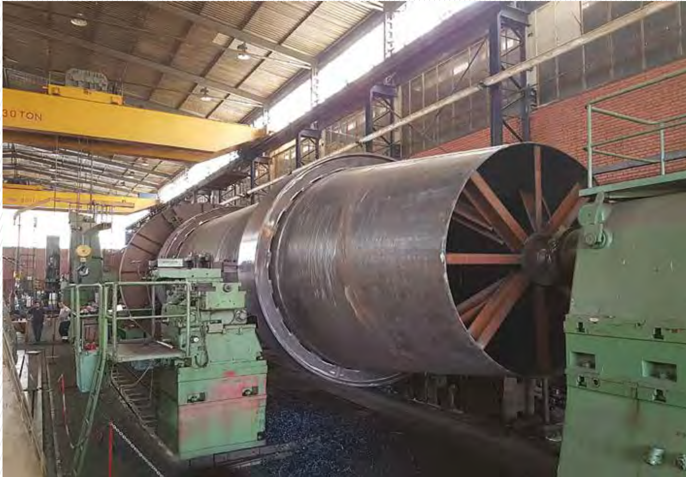
Heavy Horizontal Lathe / Ø5.500 mm L: 23.500 mm Ağır Yatay Torna Tezgahı / Ø5.500 mm L: 23.500 mm
