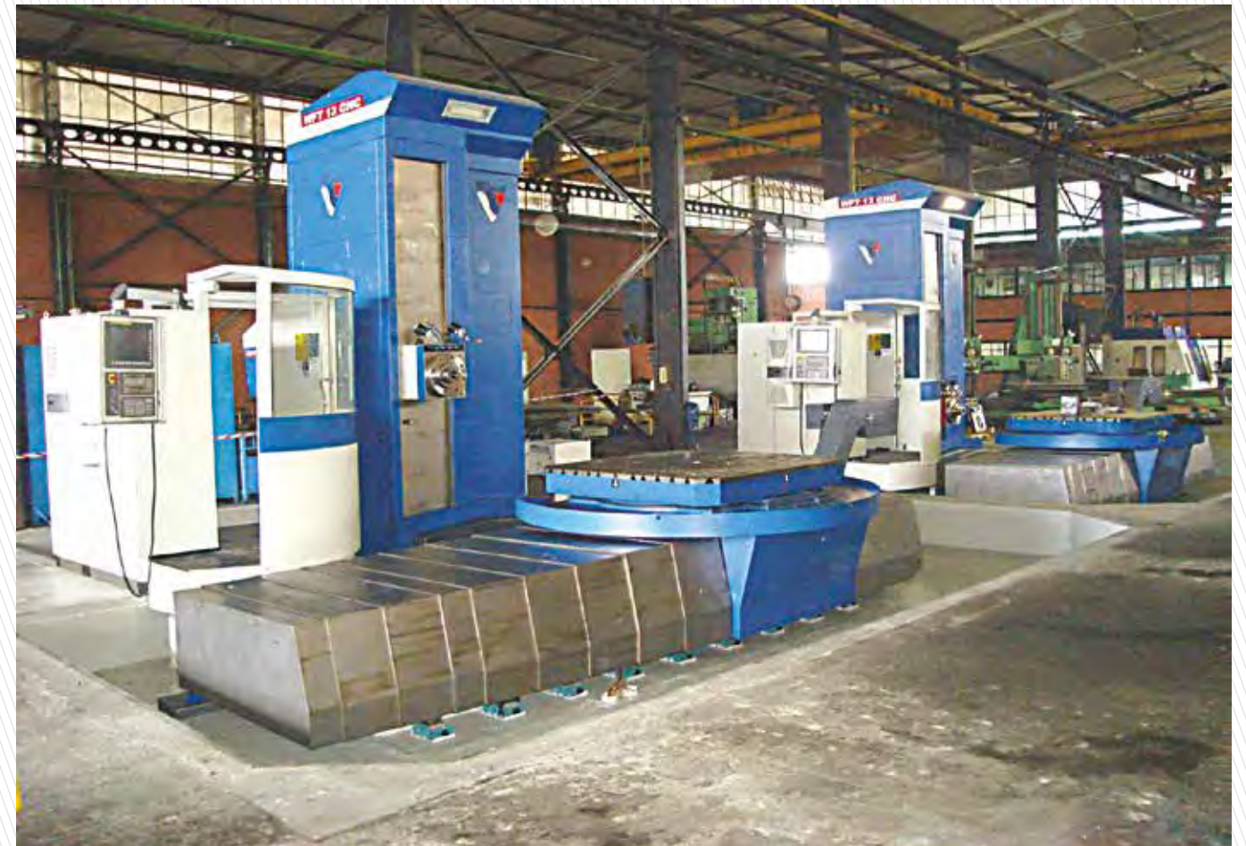
CNC Ø130 Bohrwerk with Rotary Table / 2.500 mm x 2.000 mm x 1.250 mm CNC Ø130 Döner Tablalı Borwerk Tezgahı / 2.500 mm x 2.000 mm x 1.250 mm
