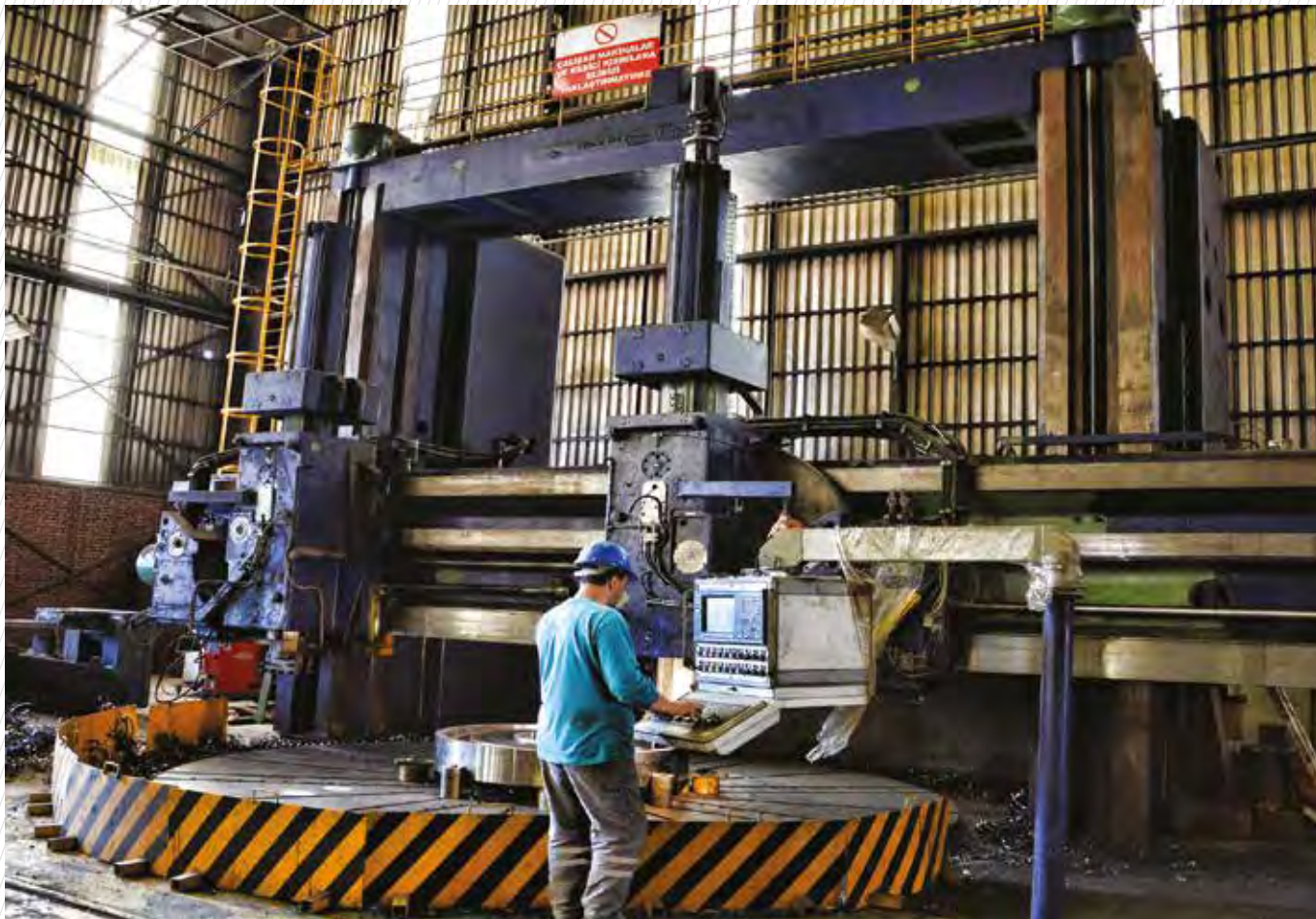
CNC Vertical Lathe / Ø: 5.850 mm h: 3.400 mm CNC Dik Torna / Ø: 5.850 mm h: 3.400 mm
