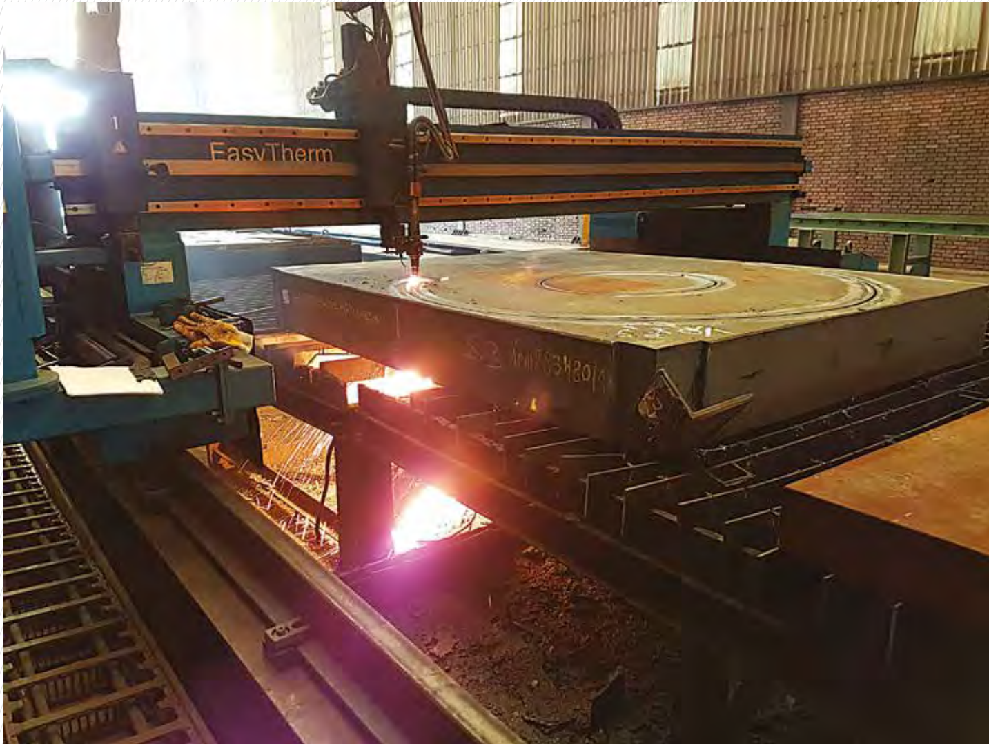
Cutting of 260 mm thickness S355J2N plate 260 mm kalınlığında S355J2N malzeme kesimi
