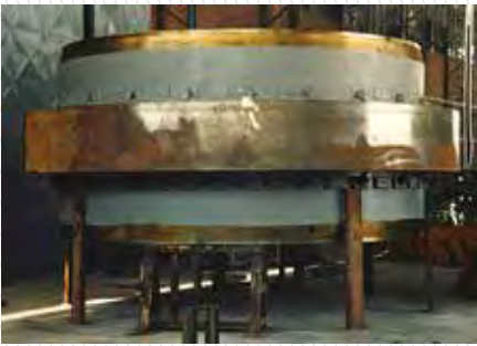
Mantel parts and ring of rotary kiln Döner Fırın Manto Parçası ve ringi
