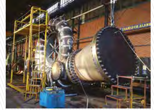
Pressure Test of a Spiral Case Salyangoz Basınç Testi
